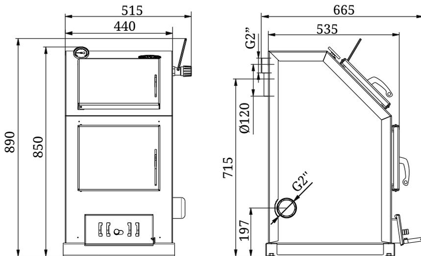
Рисунок 1. Габаритно-монтажные размеры котла «Оптимус 20 Электро»
